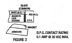
WIRING FOR D.P.S (DOOR POSITION SWITCH). DRAWING SHOWS DOOR IN OPEN POSITION
