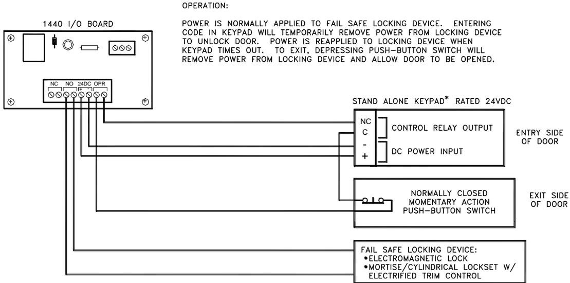
\*TO BE INSTALLED INSIDE SECURED AREA ONLY. STAND-ALONE CONFIGURATION NOT SUITABLE IN AN OUTSIDE ATTACK SITUATION.
